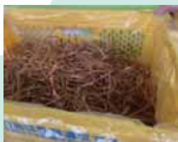
コード類の一部は分解して銅線の状態にしてからリサイクル業者へ引き渡します。
